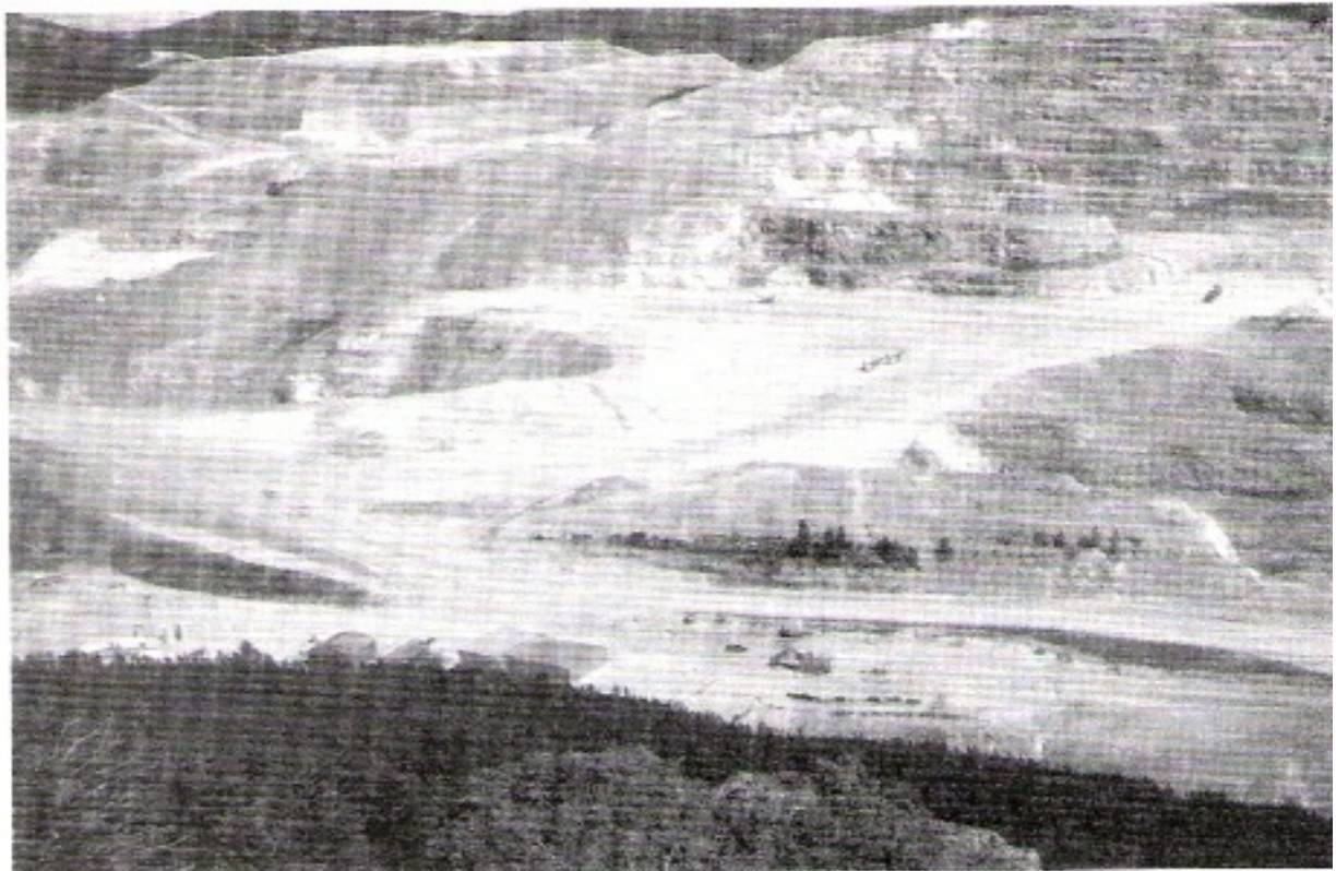
Foto 4. A mina abandonada Zortman-Landusky, em Montana, a primeira nos EUA a experimentar a extração de ouro de minério com baixo teor, em larga escala, através de lixiviação em pilha com cianeto.
